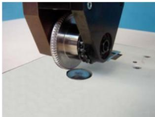
Macchina da "cucire" ad ultrasuoni per il taglio e/o saldatura di tessuti termoplastici e film.
